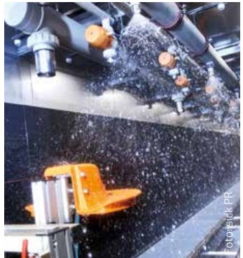
Wassertunnel zum Testen von Sensoren für Außenbereiche (Symbolbild)
